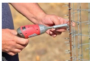
Figure 1 : Easytied ® tordant une agrafe sur une barre d'armature de 10 mm et un Protecteur Cactus ® . Fig. 2-3 : arbres protégés par un Protecteur Cactus ® .
